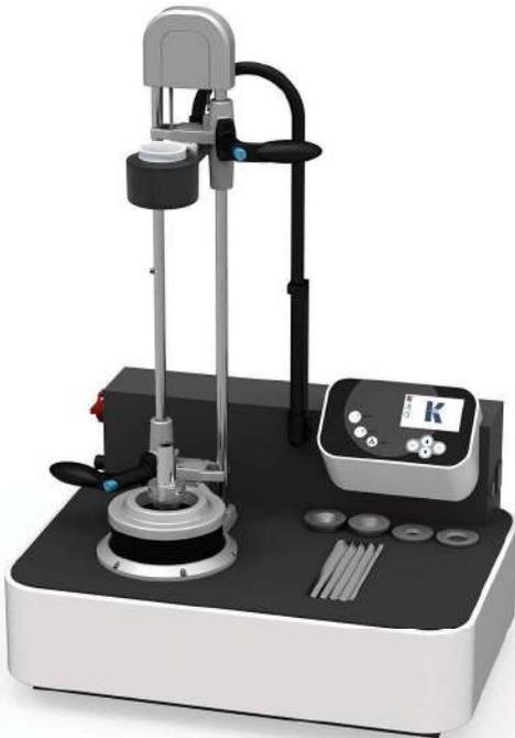
Das KEMMLER Induktions-Schrumpfgerät „KSG 2020“ mit zusammenfaltbarem Kühlturm stellt den Aufstieg zum effizienten Schrumpfen mit integrierter Flüssigkeitskühlung dar. Schrumpfen und Kühlen findet in einer Position ohne Handling der Schrumpffutter statt. Das Induktions-Schrumpfgerät „KSG 2020“ eignet sich zum Schrumpfen von HM-Schäften Ø 3 – 32 mm und Stahlschäften Ø 6 – 32 mm.
